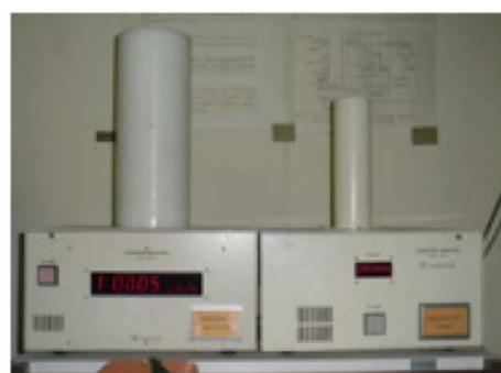
図 1：放射線モニター（右：中性子線用、左：γ 線用）
