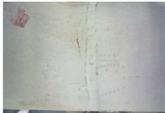
図 5：浸透探傷検査
