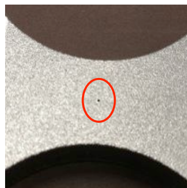
レーザーピーニン グ処理された試験 片への穴あけ加工 (φ0.2)
