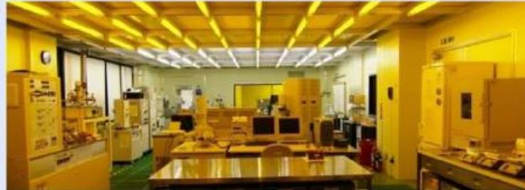
すずか1ヶ台キャンパスの創造研究棟の3階にある未来産業技術研究所の「100m<sup>2</sup>のクラス1,000のクリーンルーム」と「90m<sup>2</sup>のクラス1,000のクリーンルーム」、
