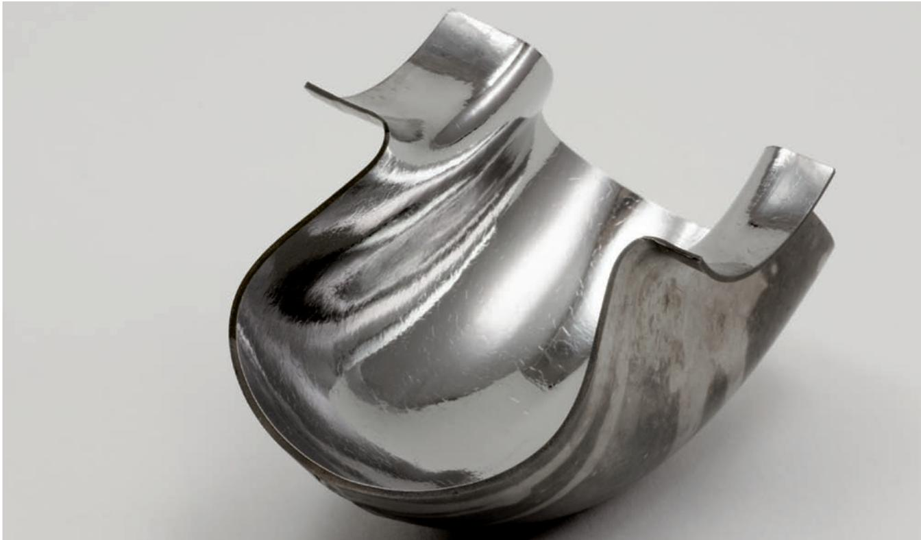
鏡のように光る電解研磨後の超伝導空洞内部。ひとつの空洞セルを4分割したもの。内表面にみえる網目状のパターンは、熱処理のために再結晶したニオブ(結晶粒塊と呼ばれる)の結晶の境界が見えているもの。
