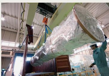
コンテナから取り出される、S1-グローバル試験用イタリア製クライオモジュール
