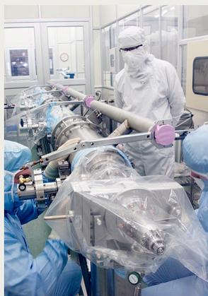
人氏(KEK)だ。大内氏は、引続き、これら4台の空洞の冷却試験装置への組込み作業を担当する。「クライオモジュールを冷却するまでは、本当の成功かどうかは分かりませんから」と、大内氏は気を引き締める。2月には、イタリア国立核物理学研究所(INFN)から3名と、フェルミ研からの1名のエンジニアチームが、クライオモジュールの組立を行うためにKEKを訪問。さらに、KEKの作業チームが、2月に4台の日本製空洞連結のために、クリーンルームでの作業を開始した。システムテストは、2010年中頃に始まる予定だ。
