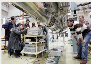
S1 グローバル用の米国製空洞の周波数チューナーの試験運転中の伊米日合同研究チーム
