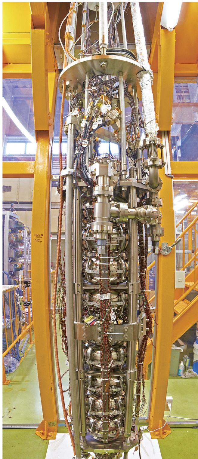
KEKで縦置き試験準備中の中国科学院・高能物理研究所 (IHEP) 製超伝導空洞。銀色の球体が連なっているように見えるのが、空洞本体。試験用にたくさんの線が取り付けられている。
