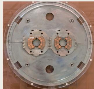
LHC の超伝導磁石のカットモデル。ビームの進む向きに垂直な断面で切ったもの。層状に見えるブロンズ色のものが超伝導体によるコイルの断面。LHC では2つの陽子ビームを逆向きに廻して衝突させる。そのために極性の違う2つの超伝導磁石を1つにまとめた 2-in-1 と呼ばれる構造をしている。
