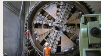
TBM 型トンネル掘削機。画像：DESY
