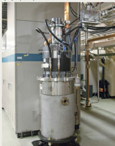
KEKB等への入射器として使われている線形加速器に使用されているクライストロン。高さ約2mの縦型である。電子ビームは下から上へと打ち上げられる。上部に出力空洞がありそこで作られた電波が導波管(銅で出来た四角いパイプ)を通過して線形加速器の加速管へと運ばれる。
