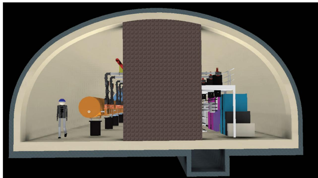
新しく提案されたカマボコ型トンネル。トンネルの大きさは、幅およそ11メートル、高さ5.5メートル。厚さ3.5メートルの壁で2つの部屋に分けられている。カマボコ型を説明するために、会議に参加した外国人研究者には、本物のカマボコが配られた。画像提供: KEK CFS グループ
