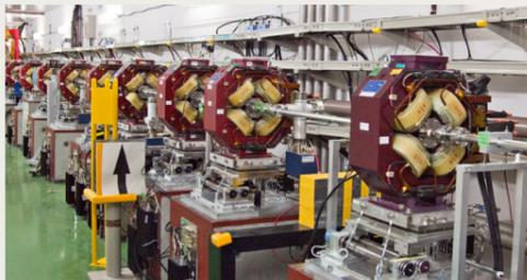
KEK の先端加速器試験施設(ATF)の最終収束ビームライン。たくさん並んでいる赤い八角形のものが収束用電磁石。その中心部を貫いて銀色のパイプ、ビームパイプ、が続いている。
