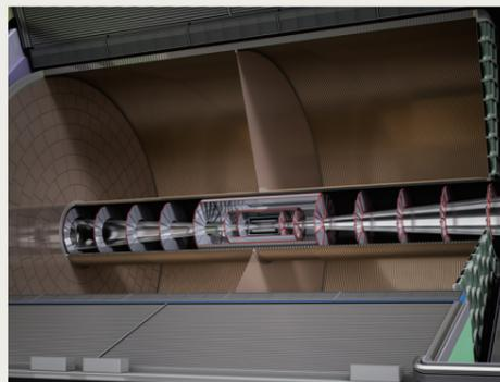
ILD測定器の内部。茶色のがらんだ部分がタイム・プロジェクション・チェンバー。本文では省略したが、実物は全長約2.5m、直径約4mの茶筒が底同士をくっつけて繋がっている。真ん中が共通の底で両端に蓋がある。イラストの真ん中に見える仕切り板のような物が共通の底である。クレジット: Rey.Hori
