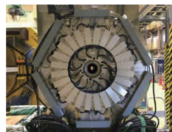
超伝導磁石と3000ch.の検出器からなるミュオンスピン分光器
