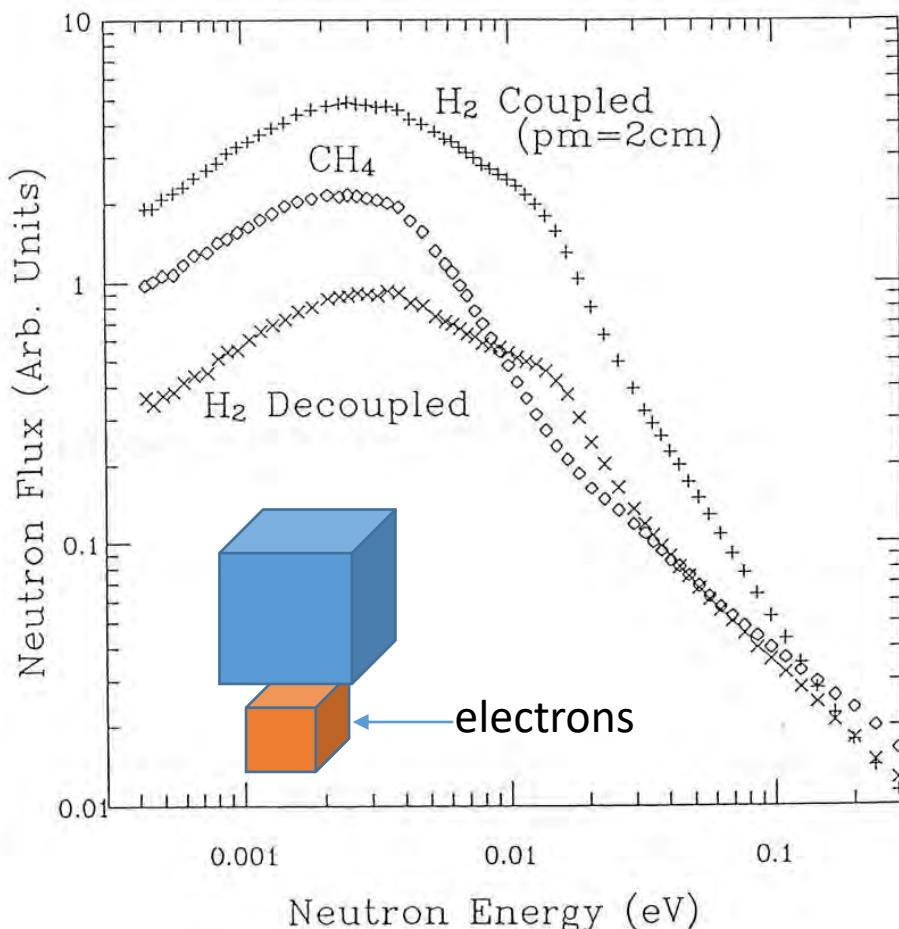
図6.12 カップリング型液体水素とデカップリング型固体メタンの中性子スペクトルの比較
