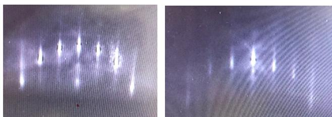
図 1. アニール時間の異なる試料の RHEED パターン。(左) 590°C 3 秒 (右) 420°C 120 秒。
