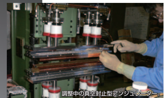
調整中の真空封止型アンジュレーター。
