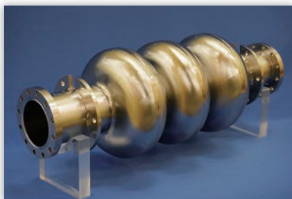
ILC 実現に向けた低コスト材料を用いて製造した超伝導加速空洞
