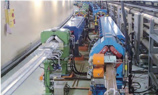
KEKB 加速器は電子と陽電子を正面衝突させる周長 3 km の円形加速器で、Belle 測定器とともに 2001 年に B 中間子と反 B 中間子の対称性の破れを発見し、2008 年の小林・益川両氏のノーベル物理学賞受賞に貢献しました。SuperKEKB はこの KEKB を大改造して B 中間子などの生成能力（ルミノシティ）を KEKB 実績値の数十倍に高めたものです。2016 年の試運転の後、陽電子ダンピングリングの建設、主リングへの Belle II 測定器とビーム最終集束用超伝導電磁石の設置、2018 年 3 月～7 月の衝突調整などを経て、2019 年 3 月に本格的な物理実験を開始しました。
