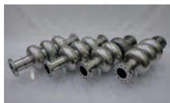
低コスト材料を用いて製造した超伝導加速空洞 SuperKEKB 用フラックスコンセントレーター
