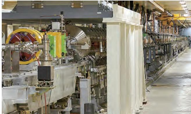
電子・陽電子線形加速器は、SuperKEKB と放射光加速器 (PF、PF-AR) に高エネルギーの電子・陽電子ビームを供給するための全長約 600m の加速器。電子ビームには、強力なパルスレーザーをレアアース合金に照射した時に放出される電子を使います。陽電子ビームには、電子ビームをタンゲステンに衝突させた時に発生する陽電子を使います。加速管のパラメータや電磁石の強さを約 20 ミリ秒毎に調整することで、各リングにそれぞれに必要なエネルギーの電子、あるいは陽電子をほぼ同時に振り分けて供給します。
