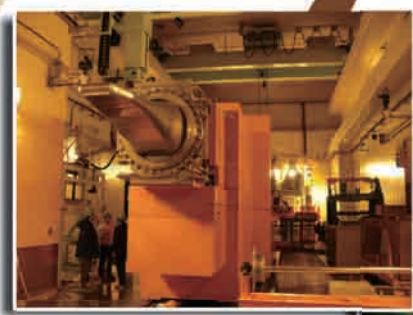
中性子生成標的 中性子を発生させるための標的台車。台車内で標的の水銀が循環し放熱する仕組みです。
