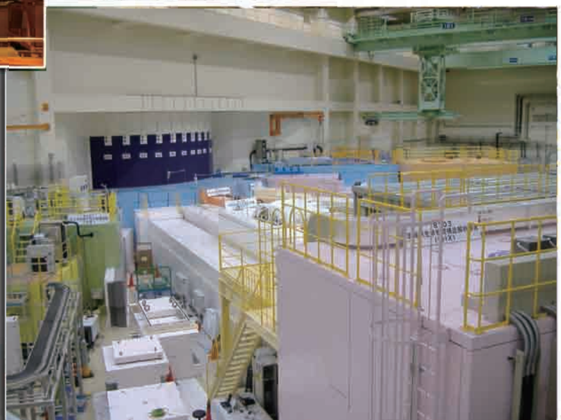
物質・生命科学実験施設の内部 画面左中ほどの紺色の中性子源ステーションから右下に向かって、白色の遮蔽体に覆われた中性子ビームラインが伸びています。
