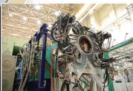
中性子生成標的 中性子を発生させるための標的台車。台車内で標的の水銀が循環し放熱する仕組みです。
