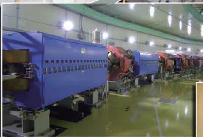
3GeV 陽子シンクロトロン 線形加速器から送り込まれる陽子を加速するための電磁石がリング状にずらりと並ぶ陽子シンクロトロン。 陽子を30億電子ボルト(光速の約97%)まで加速します。
