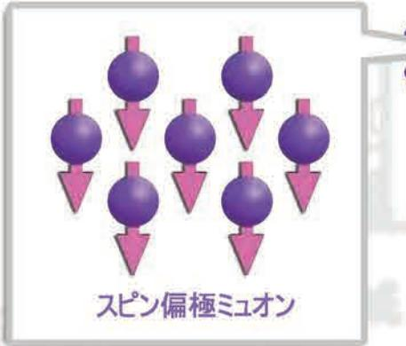
加速器を利用して生み出したミュオンビームのミュオンは、スピンの向きが進行方向にそろっています。これらは「スピン偏極ミュオン」と呼ばれます。
