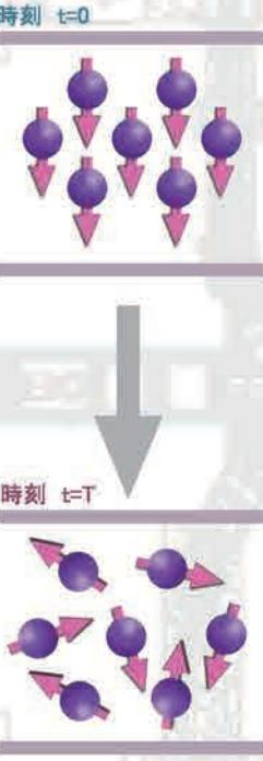
それぞれのミュオンは内部磁場を感じ、スピンの向きを変えます。そのため、全体として見た場合、初期のミュオンスピニンの偏極度は時間とともに失われます。偏極度の時間変化を追うことで、物質内部の電子状態を調べることができます。
