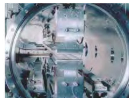
1990年12月 PFで開発された世界初の真空封止型アンジュレーター（AR-NE3A）。この技術により、中型放射光施設でX線領域の高輝度光を発生することができ、今では世界の放射光施設で使われている。
