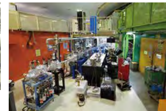
2021年現在、PFで最も新しいビームラインBL-19。走査型透過X線顕微鏡（STXM）常設のAブランチ（右）とフリーポートのBブランチ（左）から構成される。
