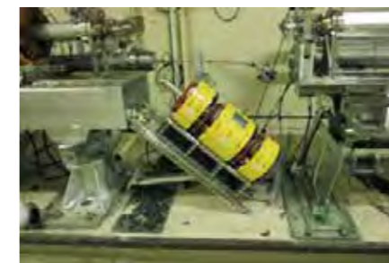
2011年 東日本大震災により、KEKの加速器の多くが被害を受けた。写真は、地震により転落した入射器のトリプレットQマグネット。KEKでは、多数の共同利用者に利用されているPFの復旧を最優先です。5月23日には震災後に初めて放射光を装置に導入でき、秋からは共同利用実験を再開した。
