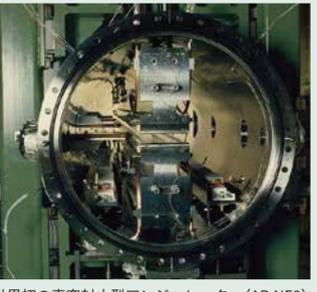
世界初の真空封止型アンジュレーター(AR-NE3)
