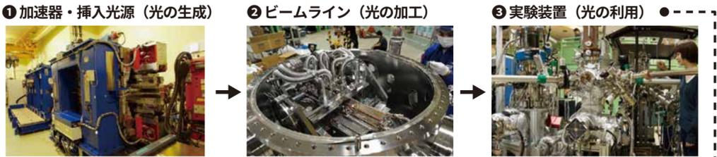
アンジュレーターなどの挿入光源技術の発展により、高輝度で偏光制御された光が得られるようになりました(写真：アンジュレーター)。
