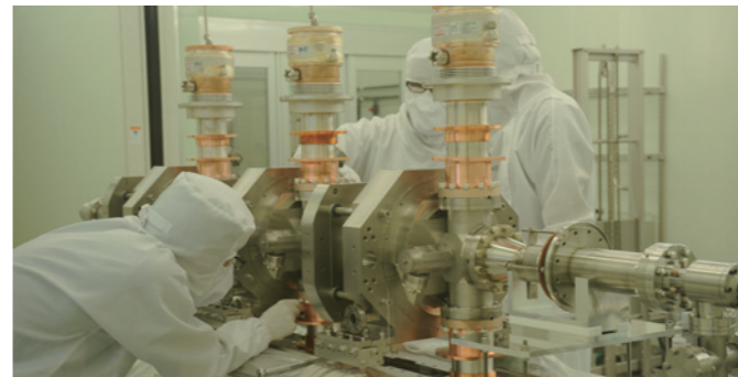
入射器用超伝導空洞モジュールの組み立て作業
