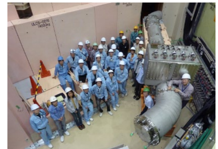
右側 S 字状の円筒形のものが超伝導湾曲ソレノイド電磁石
