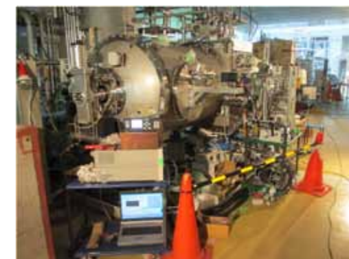
主加速部超伝導空洞の大電力試験の様子
