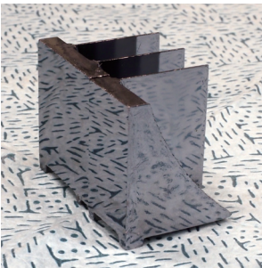
レーザー干渉計のための鏡面をつくりこんだマッハ・ツェンダー型 X線干渉計
