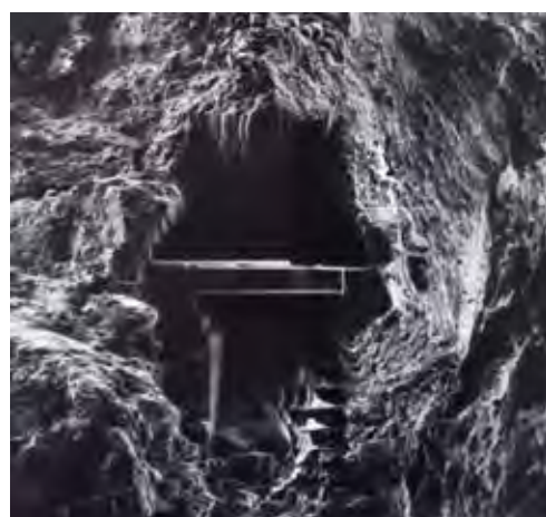
見たい場所を掘り出す FIB 作業中の画面 10 \mu\text{m} \times 5 \mu\text{m} \times 1 \mu\text{m} 程度の大きさに掘り出してから、先端を数百 nm まで薄くして STXM 分析に持ち込む
