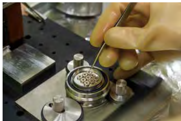
グローブボックス内で試料を扱っているところ ドーナツ状の磁石の中心に細いガラス管があり、その中に試料がついた針が挿入してある
