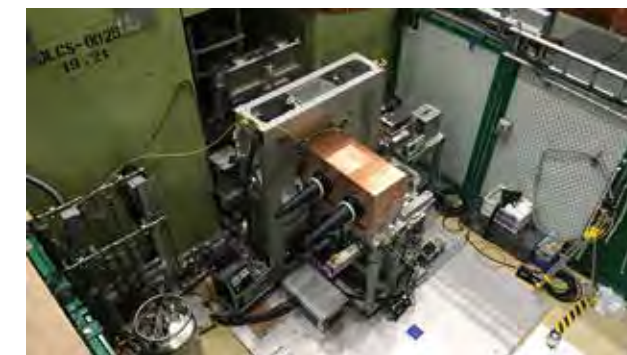
J-PARC MLF MUSE ミュオン基礎科学実験装置 D2 にリュウグウ試料のための分析関連装置を設置したところ (2021 年 4 月 竹下聡史氏撮影) D2 では緒方洪庵の薬瓶など歴史上希少な試料を多数、非破壊で透視してきた
