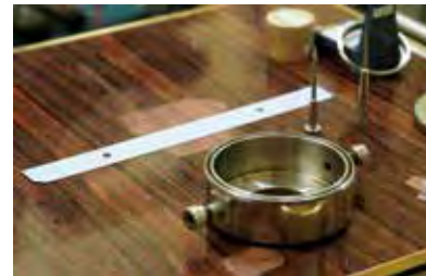
ガンドルフィカメラとイメージングプレート(IP) 細長いIPは丸めてカメラ内側に設置する
