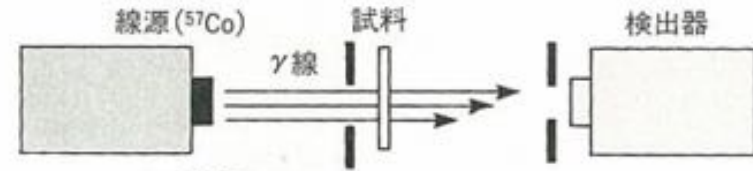
第1図 メスバウアー効果測定の実験図
