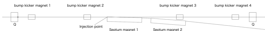
図 4-3-1: 蓄積リング入射部における入射システム機器構成
