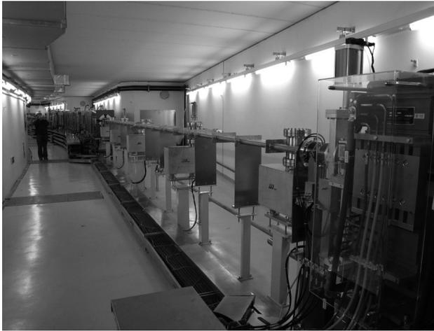
図1 12月25日、初蓄積翌日のSSRF光源リングトンネル内の様子。ここに写っている長直線部(12 m)や他の短直線部(6.5 m)にもまだ挿入光源は無く、SUS製のダミーダクトが設置されていた。
