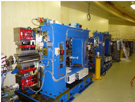
図2 PFリング B15-B16 間に設置した可変偏光アンジュレータ 2号機 (U#16-2) (手前)。奥のアンジュレータが1号機 (U#16-1)。小型の偏向電磁石は高速偏光切り替えのためのパンプ電磁石で、中央に1台、両側に2台ずつ計5台が配置されている。
