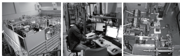
図 3 (左) 入射器棟の加速管テストベンチ制御ステーション。(中) 制御卓で作業中の Fabio Marcellini さん。(右) 加速管テストベンチに設置された INFN 製 50 cm 長 C バンド加速管。
