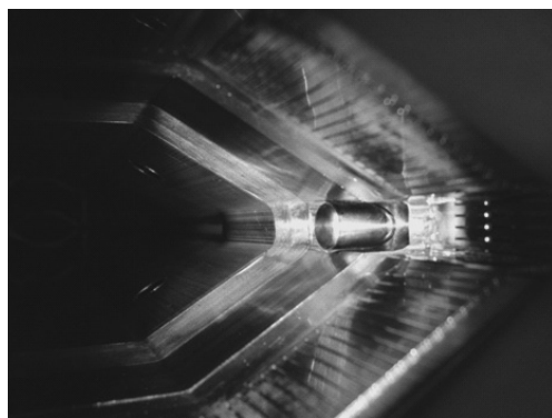
図 2 RF シールド付きゲートバルブ付近の真空チャンパー内部の様子。
