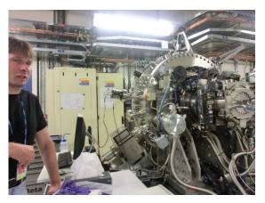
図 2 Diamond Light Source で見学した,大きなドラム型チェンバーが特徴的な軟 X 線用回折計 RASOR。左は担当者の P. Steadman 氏。
