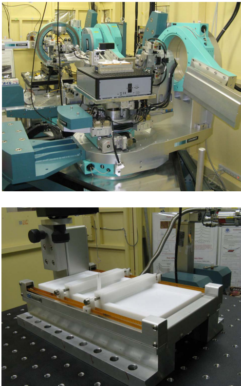
図5 (上) 現在の BL-18B ハッチ内を下流側からみた様子。写真奥(上流側)に見える \gamma サークルと 2\theta アームが第一回折計、手前(下流側)にみえる大きなステージをもつ回折計が第二回折計。(下) 第二回折計上に液体試料を設置するためのステージ、写真では除振台の上に LB 膜作成用のトラフが実装されている。
