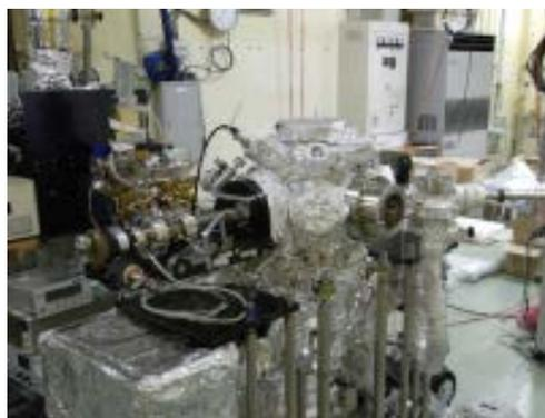
図 全反射高速陽電子回折（TRHEPD）装置の写真。右上から陽電子ビームが輸送され、中央に置かれた超高真空チャンバー内で TRHEPD 実験が行われる。
