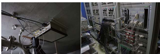
図2 (左) BPM 電極切り替え器, (右) フィードバック演算装置。
