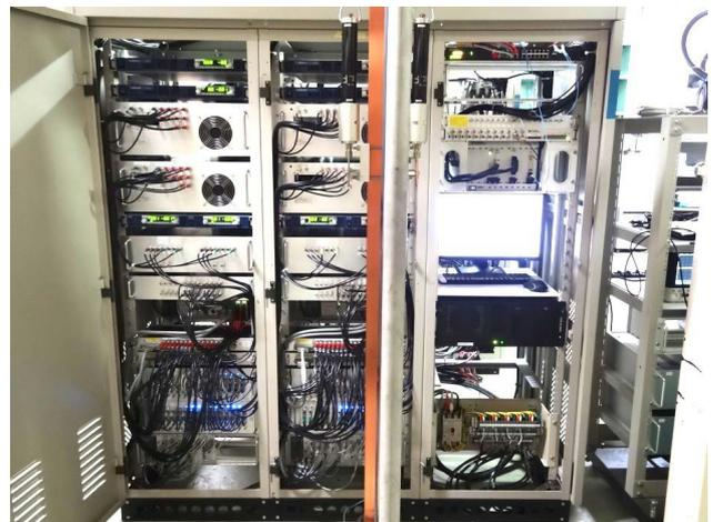
図1 パルス電磁石電源が設置された筐体
