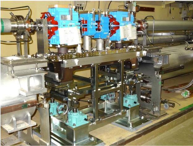
図2 加速器トンネルに設置されたパルス電磁石と架台
