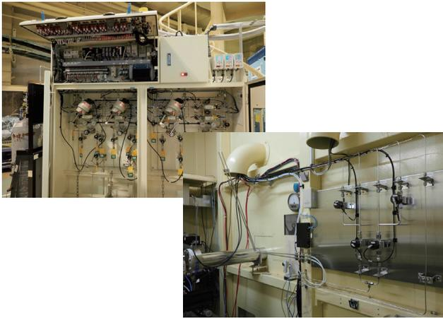
(左上) ガス反応制御システムのガスポンベ部分 (PF BL-9C にて)。この中で可燃性ガス、支燃性ガスごとの混合が行われ、実験ハッチ内へ運ばれる。(右下) ガス反応制御システムのサンプル直近の配管のようす (PF-AR NW10A 実験ハッチ内にて)。
