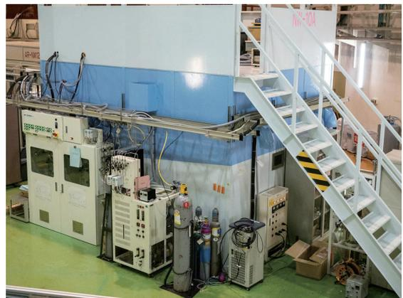
PF-AR NW10A に設置されたガス反応制御システム
