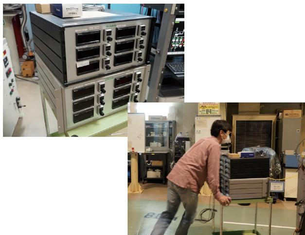
手作りのガス制御装置（左上）と装置を移動している丹羽技師
