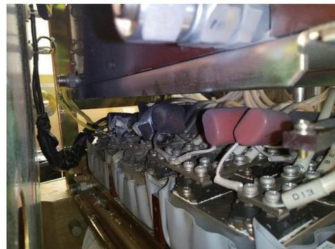
図11 焼損部（高圧ユニット背面）。奥側のコンデンサーが焼損している。コンデンサー下部はダイオードとヒートシンク。
