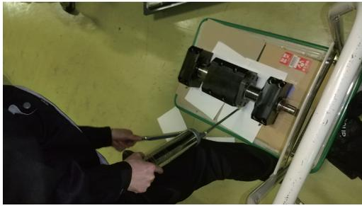
図7 グリースガンによるボールナット内グリースの入れ換え作業
