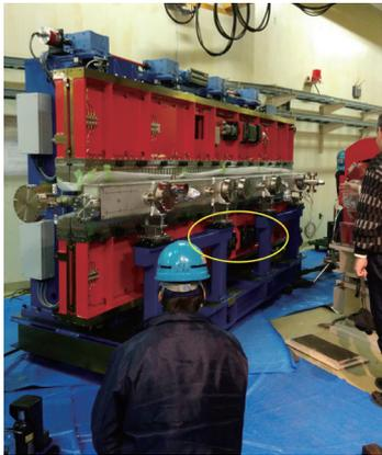
図4 設置前のアンジュレータ ID13。黄色線で囲んだ部分が故障した位相駆動系。
