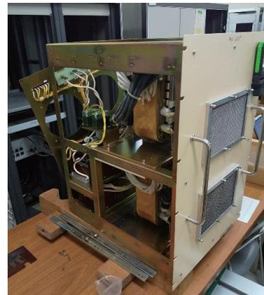
図10 故障した高電圧ユニット。背面にある高周波整流部が焼損。
