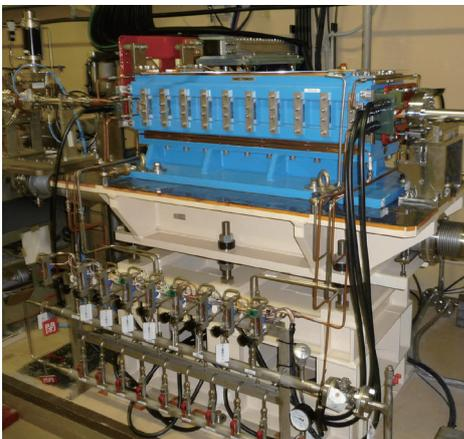
図8 入射器リニアックの終端部第3スイッチヤードに設置されているPFリングおよびPF-ARのための電子ビーム振り分けパルス偏向電磁石の写真
