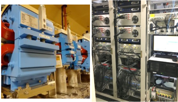
図6 パルス収束電磁石、パルス補正電磁石（左）、電源とコントローラを収めた筐体（右）。
