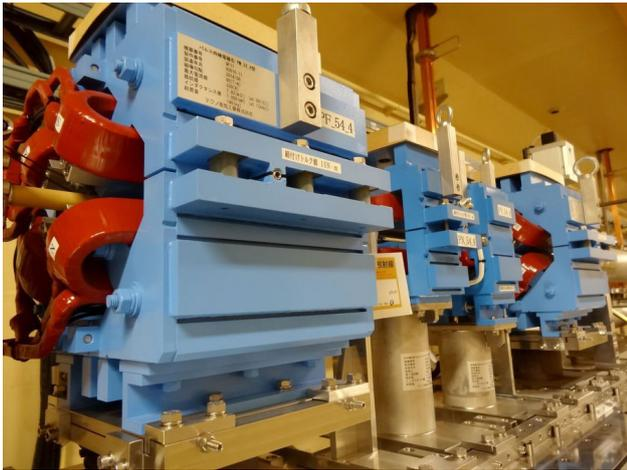
図1 入射器に設置されたパルス電磁石
