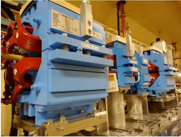
図1 入射器に設置されたパルス電磁石
