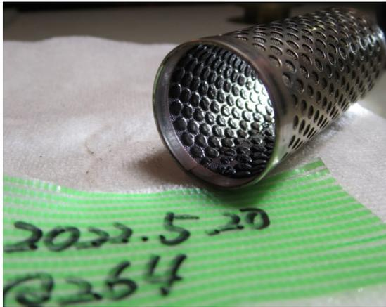
図2 メッシュが目詰まりして冷却水量低下を招いた4極電磁石 (Q264) のストレーナの写真
