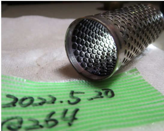
図2 メッシュが目詰まりして冷却水量低下を招いた4極電磁石 (Q264) のストレーナの写真
