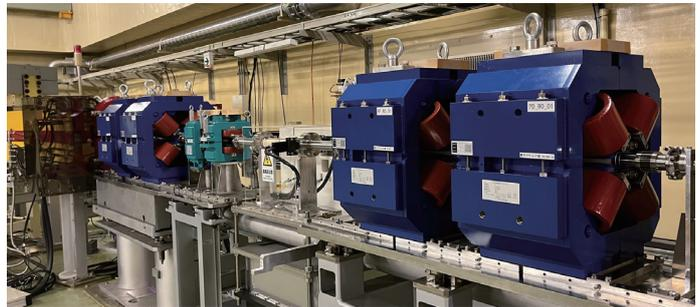
図1 J-ARC部大口径パルス電磁石の配置(左)とJ-ARC入口の実機4台(右)
