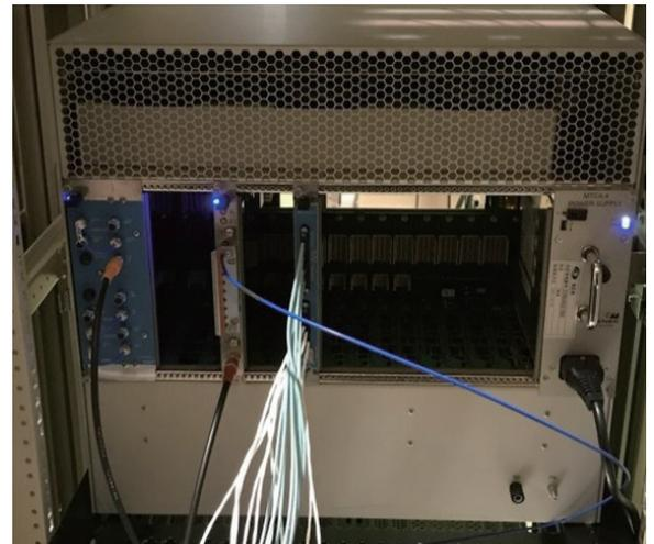
図5 試験中のデジタル・ローレベル RF 系の一部
