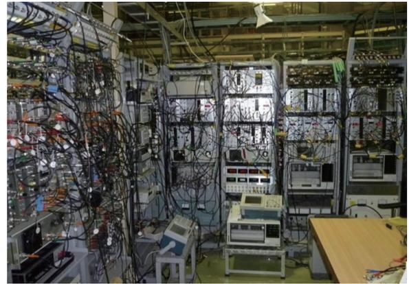
図4 PF リングの旧ローレベル RF 系
