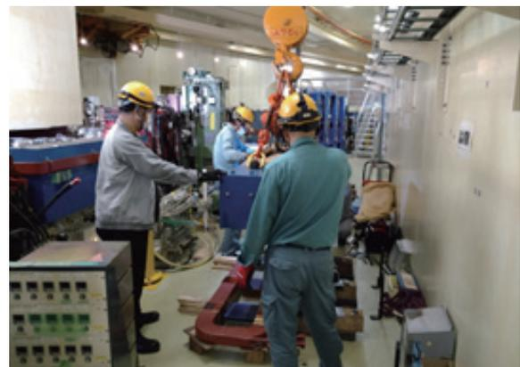
図2 交換作業風景。画面左側にあるB01電磁石を半割りして、通路側にて上部磁極のコイルを交換しているところ。
