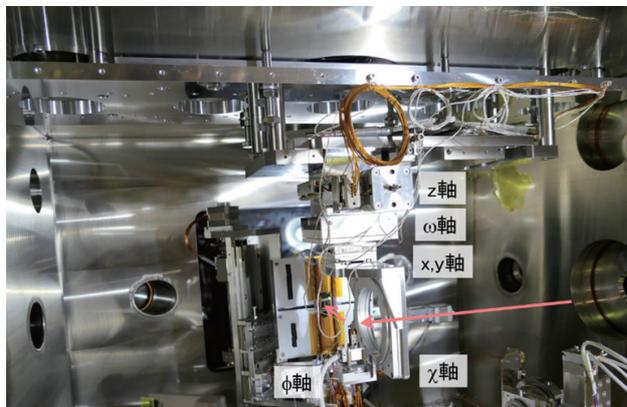
図1 反射型コヒーレント回折実験に向けて開発した回折計
