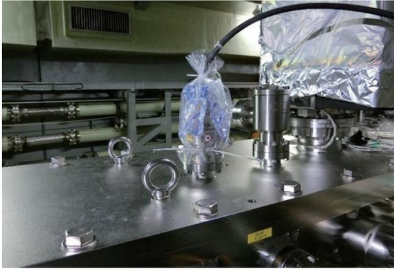
図8 湿度対策を施した例。筒状にしたビニール袋をかぶせ、中にシリカゲルを配置。定期的に中の状況をチェックして、必要に応じて交換を実施した。
