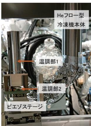
図2 He フロー型冷凍機本体と試料部を分離した小型冷凍機
