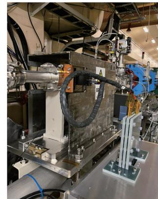
図2 1・2セクター配置の大口径パルス電磁石(左:水色)、入射器出口に設置された高速パルスキッカー(右)
