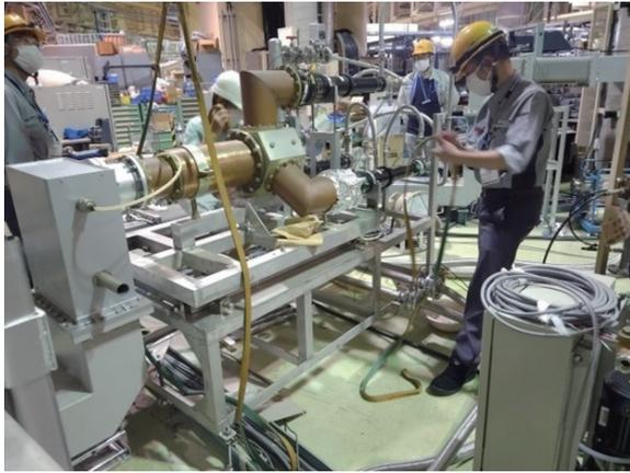
図6 ダミーロードへの接続作業
