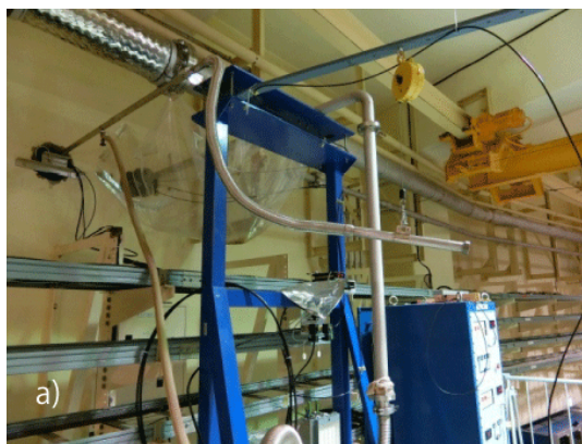
図2 超伝導ウィグラーの移送管。a) リング内側外観写真 b) 構成のブロック図。
