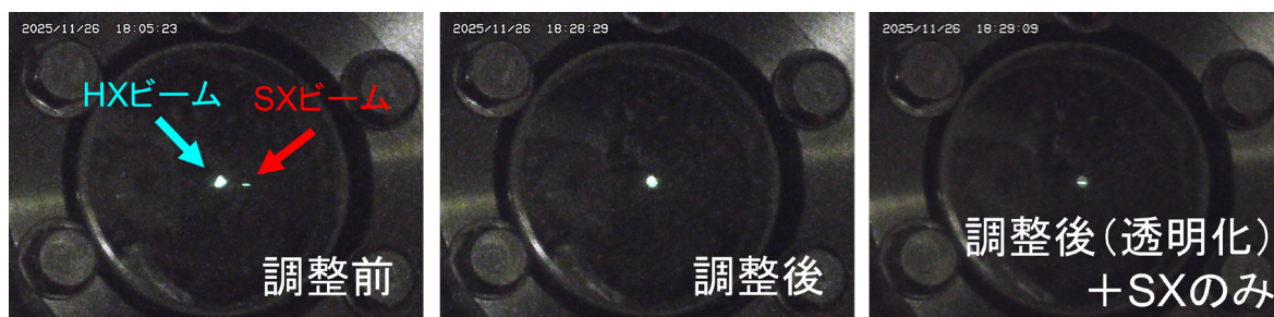
図 1 2 ビーム調整の様子。ビューポートに塗られた蛍光剤を発光させて 2 つのビームを可視化し、ミラーを調整して同位置に合わせている。右端図では、2 つのビームの重なりが見やすいように、SX ビームのみの写真に透明化させた調整後の写真を重ねている。
